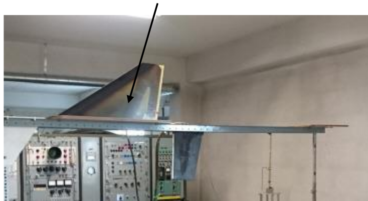
Rundstrålande mottagarantenn PN-594
