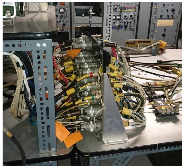
Skarvdon V61 mellan flygplanets fram- och bakkropp
