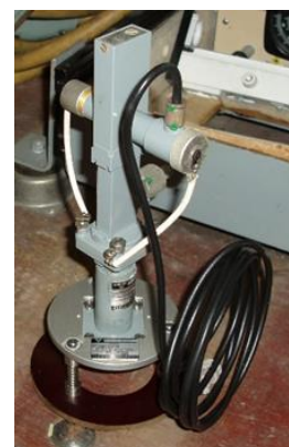
Mätadapter känslighet radarmottagaren
