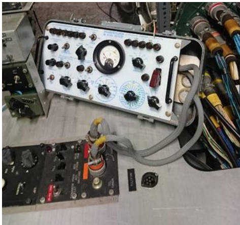
Snabbtestlådan ansluten till testuttag i kabinen
