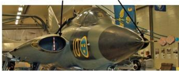
Riktantenner PN-594 (integrerade i flygplanets luftintag)
