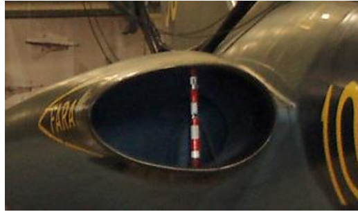
Mätadapter riktantenn PN-594
