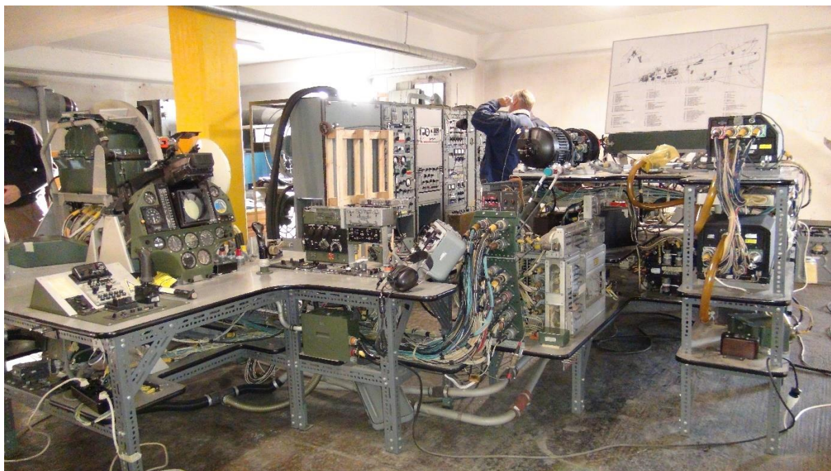
Testrigg J35J komplett med Servicebuss 405J-s testpaneler.
