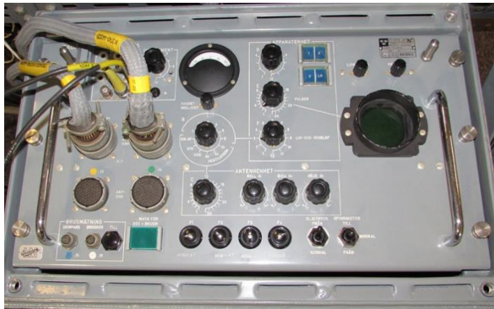
Radarprovare för anslutning direkt i testuttag i radarstativet eller antennen
